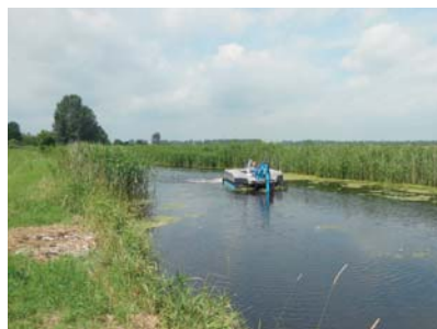
Abb. 11: Maschinelle Krautung mit Mähboot
